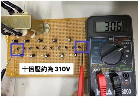
圖3：倍壓器（最大倍壓）
